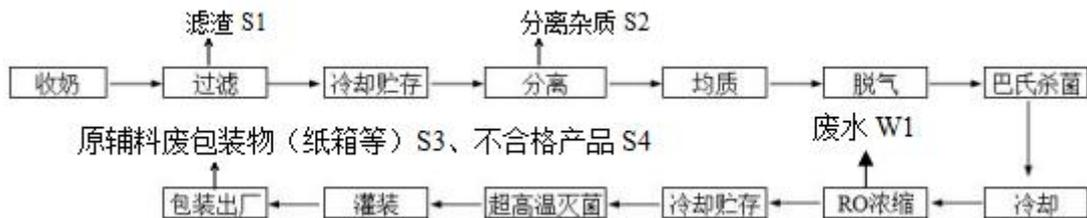
图 2-2 生产工艺流程及产污环节图
