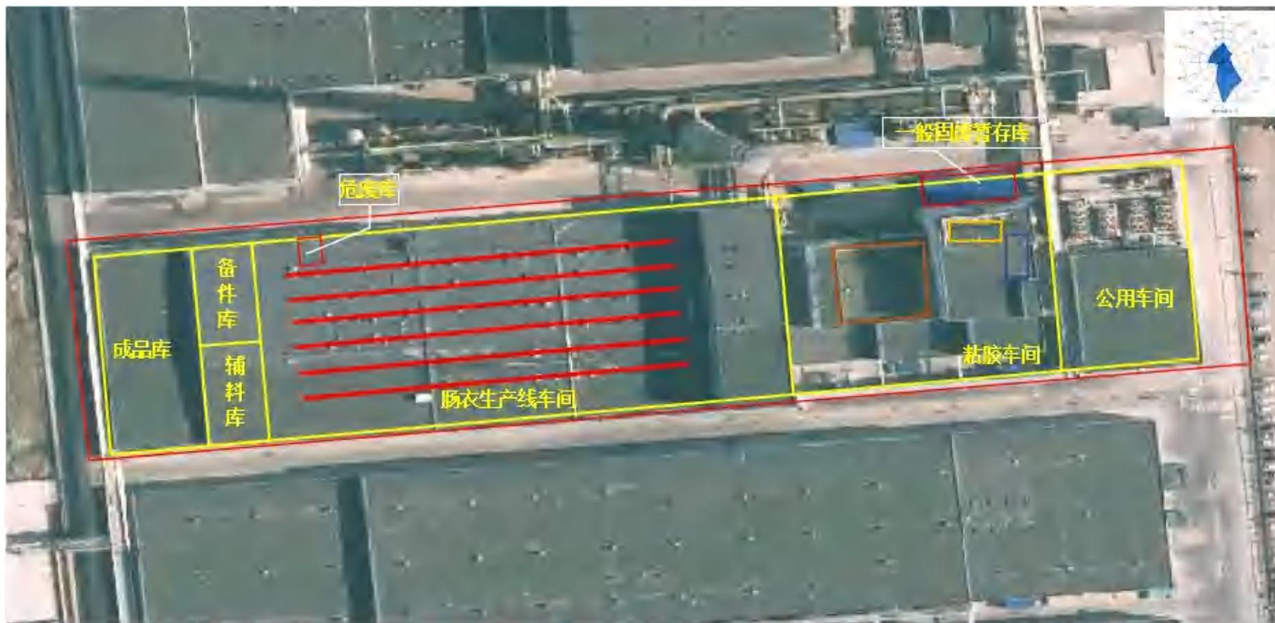
— 1#、2#、3#、4#、5#、6#生产线（从北向南依次）主要包括酸浴槽、反应槽（凝固）、反应槽（再生）、反应槽（头道水洗）、反应槽（二道水洗）、反应槽（软化）、干燥机、卷取机、真空包装机等
