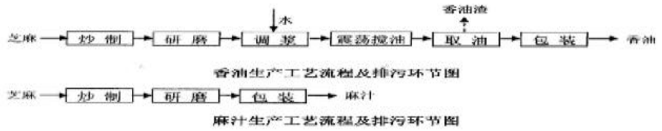
图 4.3-1 山东十笏园食品有限公司主要生产工艺流程图
