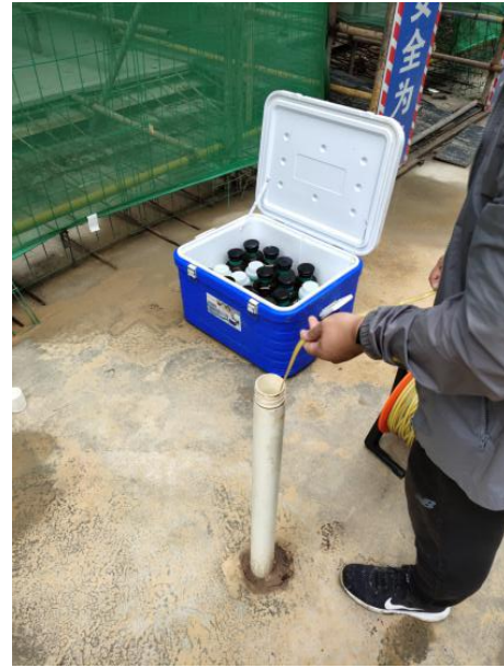
测量地下水埋深
